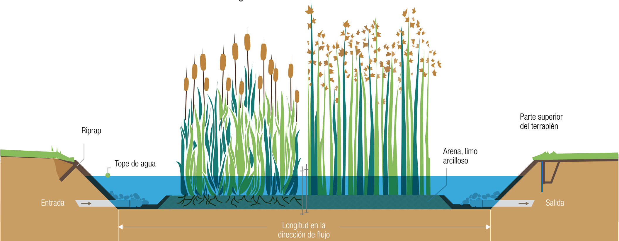
Figura 12. Humedal cubierto o subterráneo
